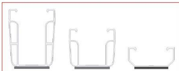
Zur Verbesserung der Modulhinterlüftung kann die Modulquermontage mit dem Kurzprofil C 47 bzw. C71 erfolgen (MV 1.1), die Montageschritte sind in der selben Reihenfolge, wie in Kapitel 5.1 beschrieben, durchzuführen.
